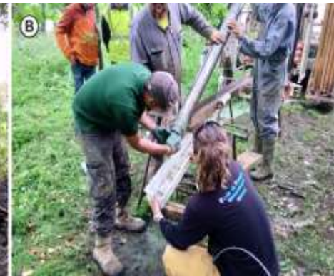
Sondages carottés réalisés sur le plateau calcaire
