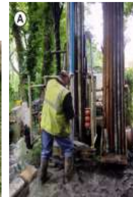
Sondages carottés réalisés sur le plateau calcaire
